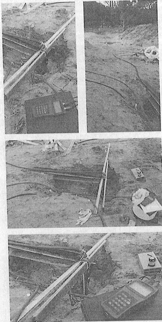
Figura 10. Equipamiento e infraestructura utilizada para prueba de bombeo. El agua extraída fue dispuesta a 100 metros del pozo de bombeo.
